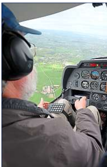
Un tableau de bord portable donne des indications sonores au pilote.
